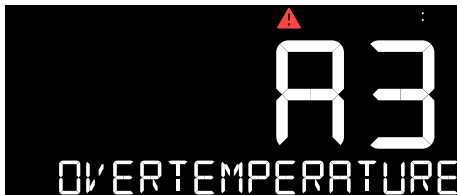
Fig. 39: esempio: allarme di sovratempertura A3 attivo
